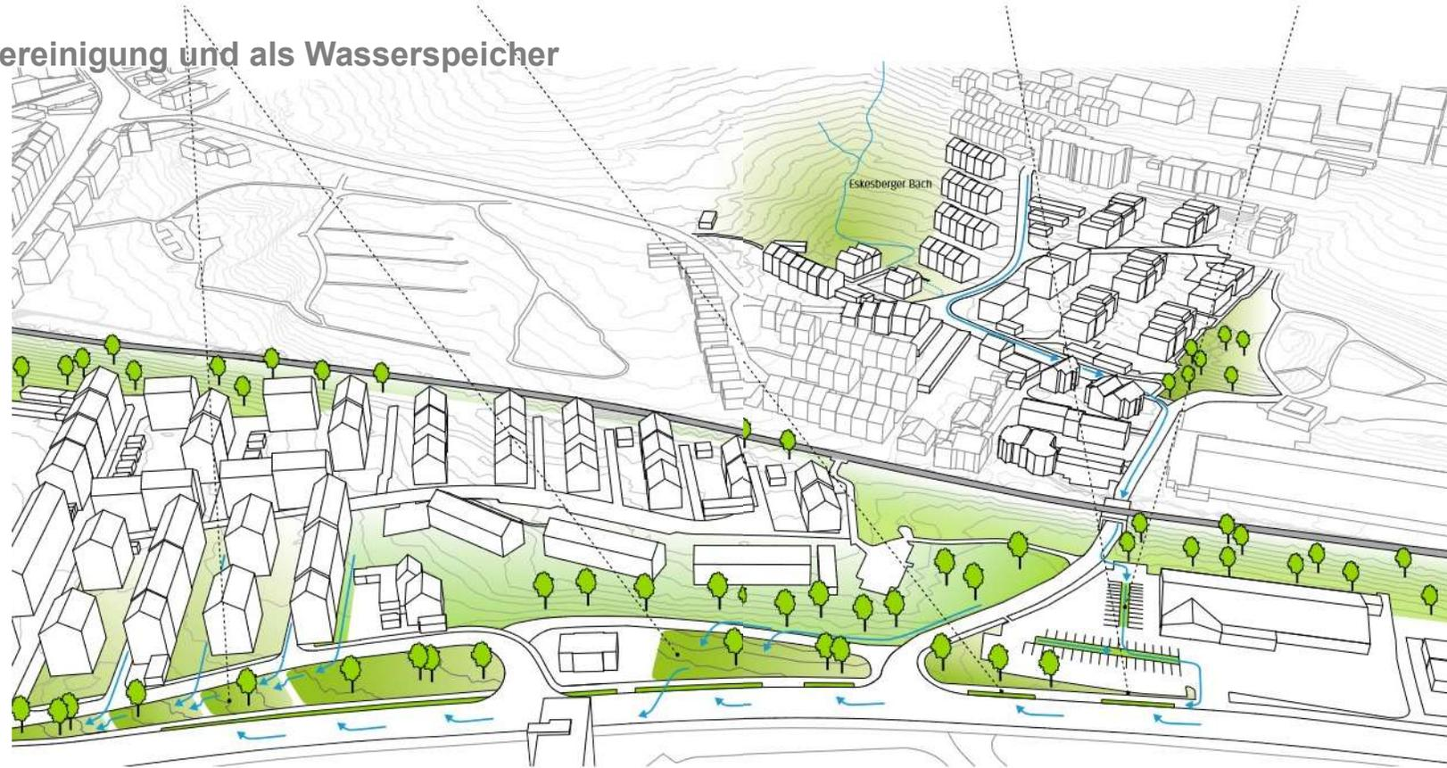
Durch die Addition von Maßnahmen in Fließrichtung entlang des Otto-Hausmann-Rings wird das Überflutungsrisiko in den Teilbereichen reduziert und vermindert die Akkumulation von Regenwasser für die weiter unten liegenden Gebiete (ILFO 2016)
